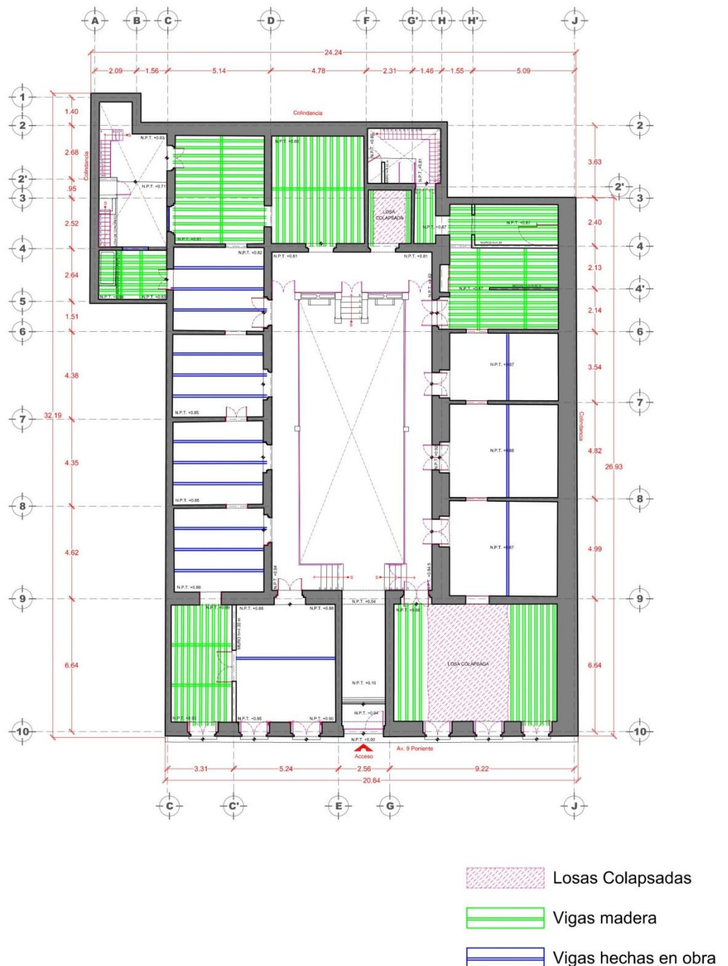
Imagen 29. Plano de sistemas estructurales en losas (Facilitado por el CECAP, modificado por Guillermo E. Morales Alva y Ana Laura Toxqui Ortiz, 2015)
