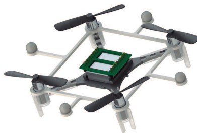
Figura 6.5. Marcadores puestos en el dron.
