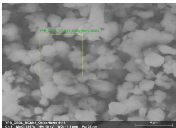
Figura 29. Área seleccionada para EDS de la muestra de MCM-41@IONP.
