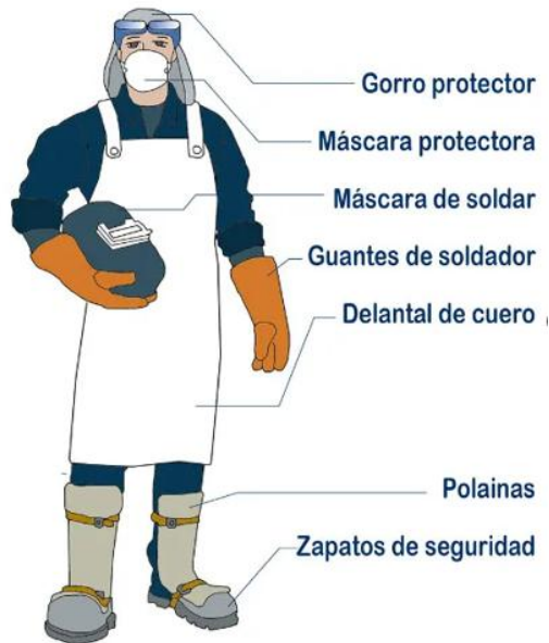
Figura 2.1.20. Equipo de protección necesario para trabajos de soldadura y corte
