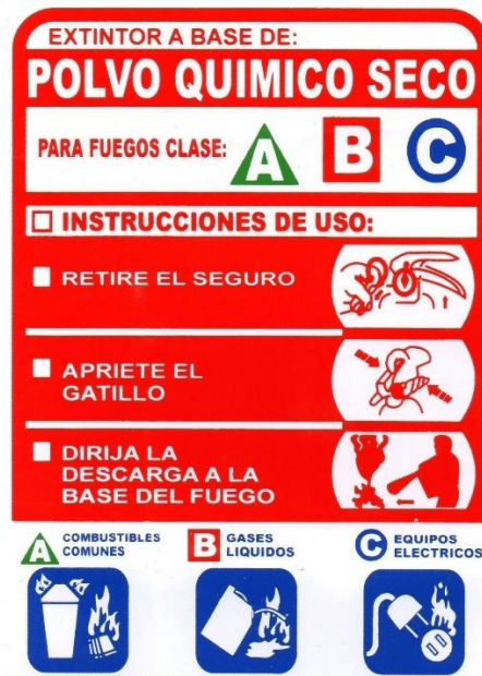
Figura 2.1.19. Etiqueta para identificar el tipo de fuego que puede apagar un extintor
