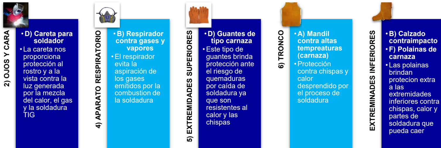
Figura 2.2.2. EPP Seleccionado para la actividad de soldadura
