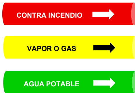
Figura 2.2.5. Ejemplo de identificación de tuberías
