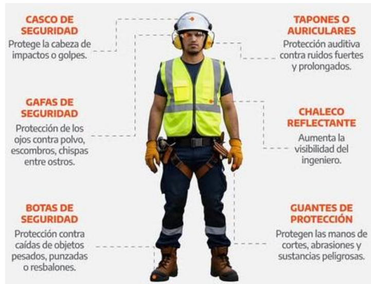
Figura 3.1. Uso correcto del EPP básico indispensable para la construcción
