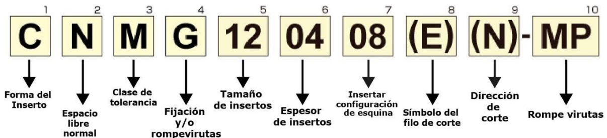
Figura 100: Nomenclatura de un inserto
