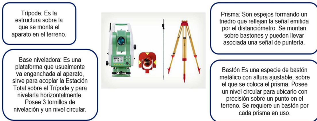
Ilustración 57. Accesorios de una estación total. Fuente: Elaboración propia, 2023.
