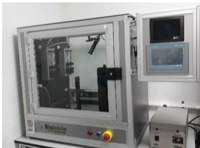
Figura 2.2 Equipo de electrohilado empleado para fabricar fibras coaxiales de PEO:QN/PEO (LE-50, Bioinicia).
