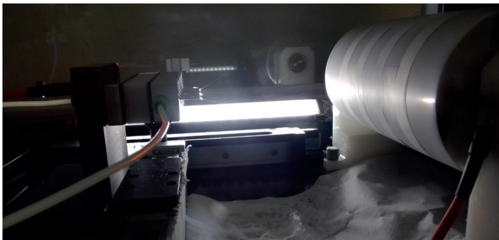
Figura 2.4 Experimento del electrohilado de fibras bicapa de PEO:QN/PEO con múltiple inyector y colector rotatorio.
