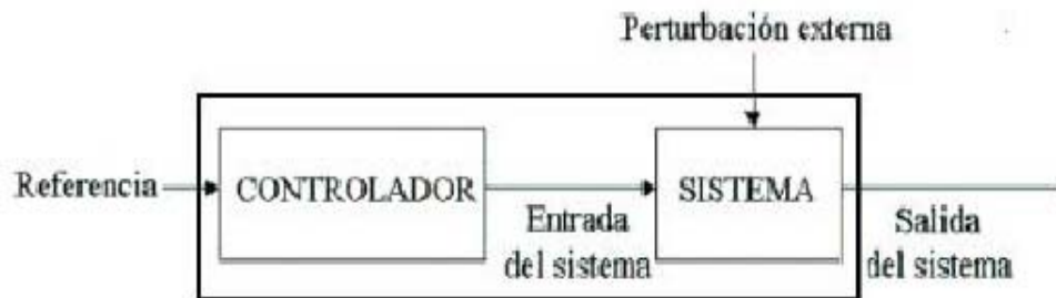
Fig. 8. Diagrama de control en lazo abierto.
