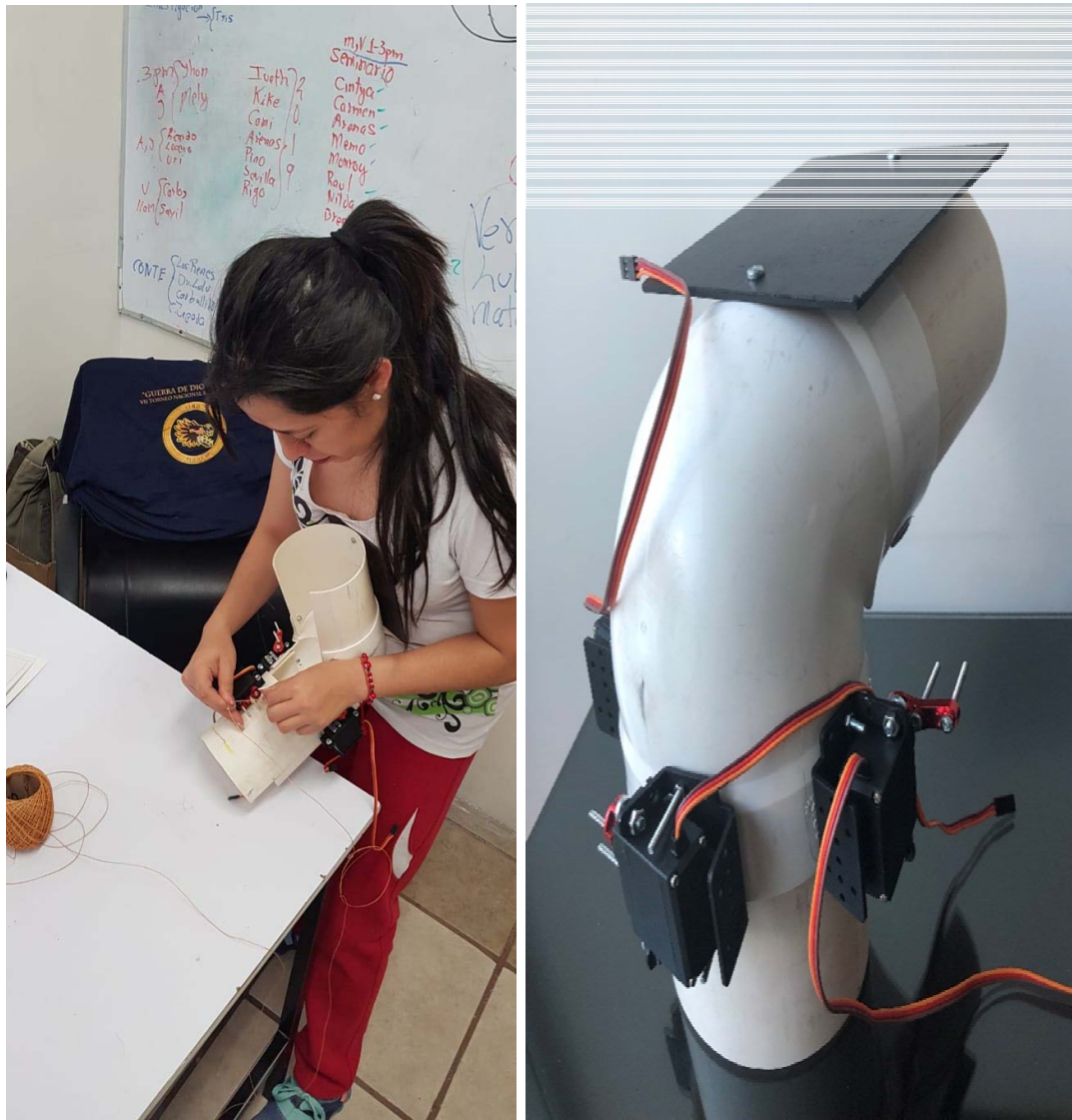
Fig. 24. Adaptación de servomotores en la rodillera y base para sistema empotrado.
