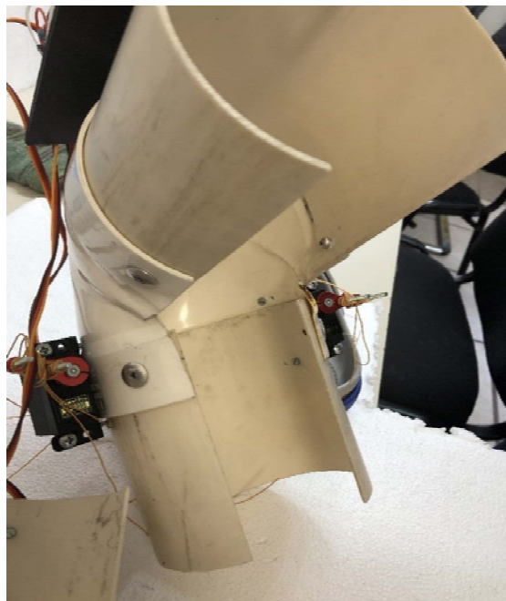
Fig.20. Cortes, pegado especial y remaches de los tubos PVC
