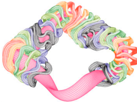
Figura 2.5: Diagrama de las bobinas externas y columna de plasma del experimento HSX de la Universidad de Wisconsin. Tomada de [7]
