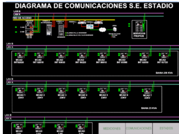
Fig. 5.4. Arquitectura de comunicaciones del Sicle.
