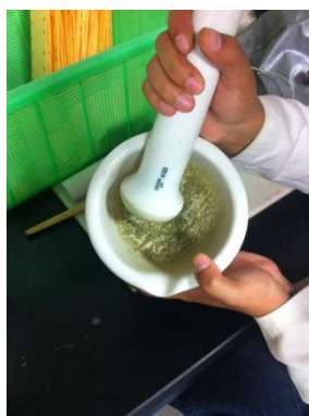
Fig. 13 Molido de muestras secas en mortero de Ágata.
