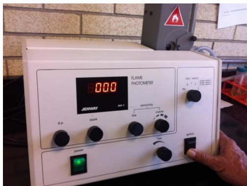
Fig. 16 Fotómetro de llama JENWAY PFP7
