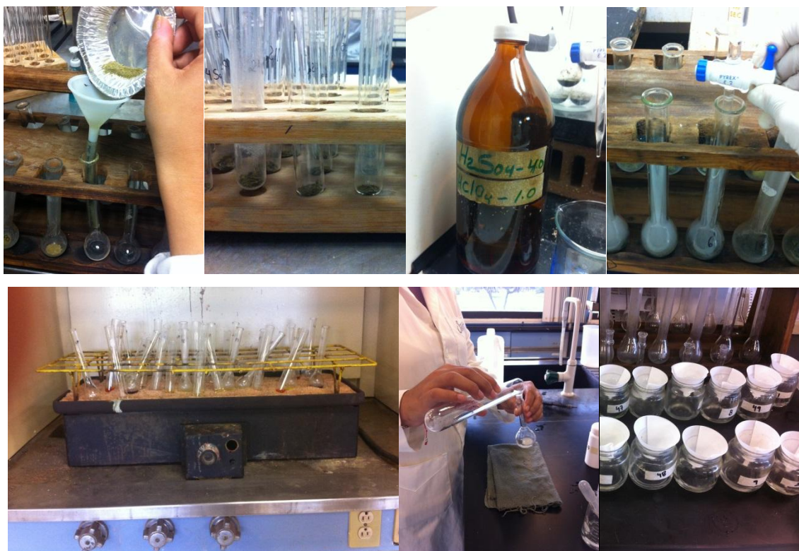
Fig. 14 Preparación de muestras para determinación de nutrientes. a) Vaciado de las muestras en tubos de vidrio, b) tubos con muestras, c) mezcla binaria, d) adición de mezcla binaria y H_2O_2 a muestras, e) colocación de tubos en plancha, f) aforación a 25 mL y g) filtrado de las muestras.
