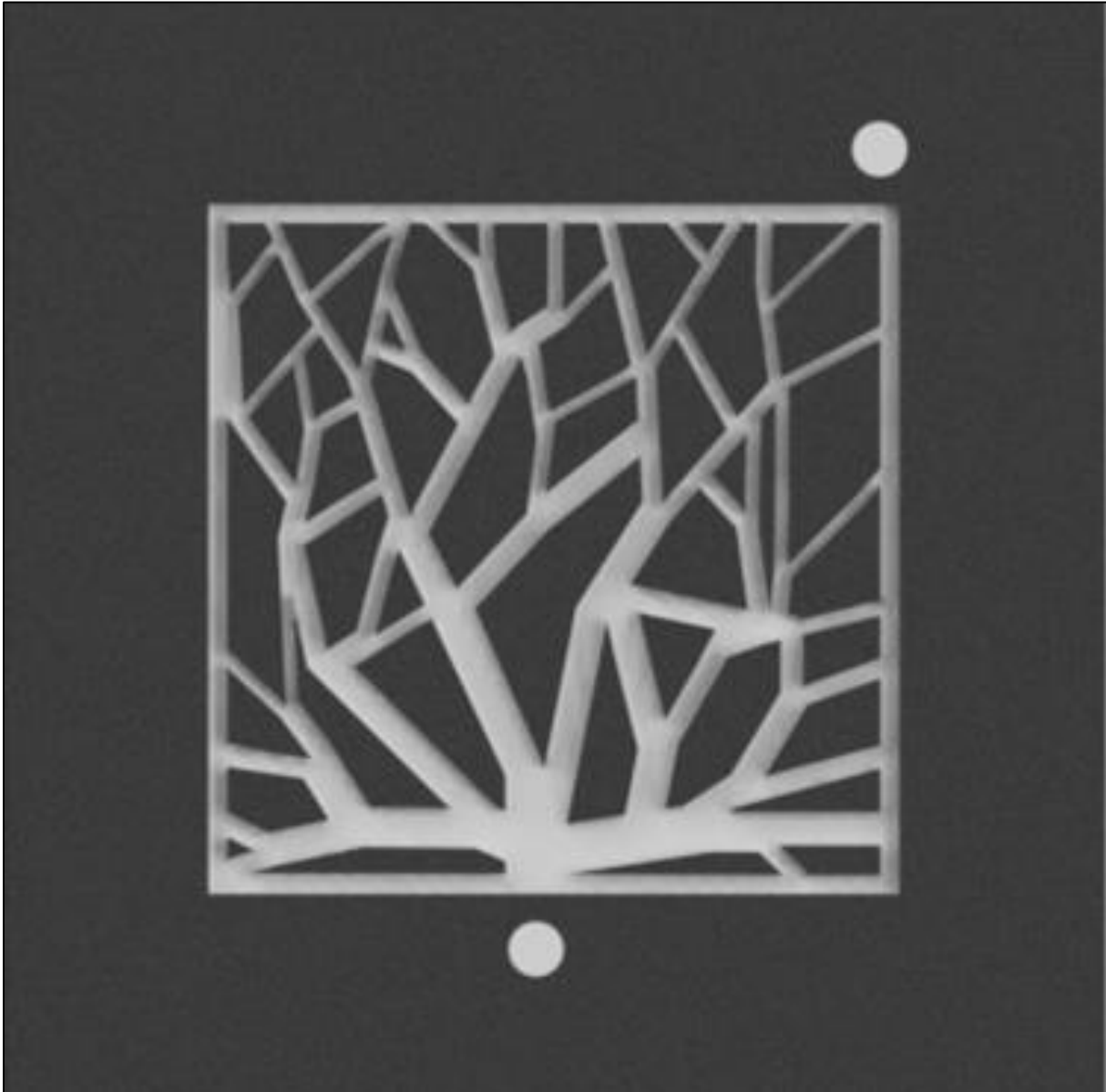
Ilustración 4.4.8 Diseño final de canales de flujo biomiméticos (arterias) Fuente: Elaboración propia
