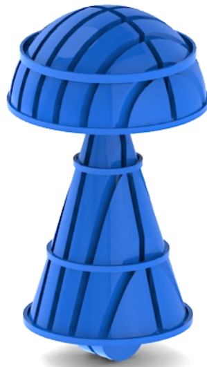
Figura 16 Simulación de lente dieléctrico tipo hongo.
