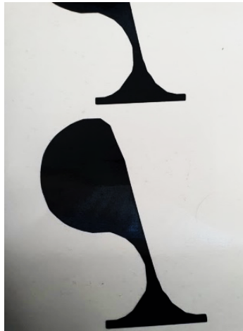
Figura 20 Corte vinil del diseño para la antena Vivaldi.
