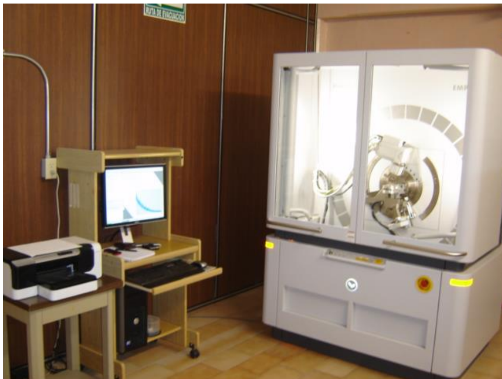
Figura 2.3. Difractómetro Panalytical – Empryean para análisis de polvos. Ubicado en el laboratorio de difracción de Rayos-X del IFUAP.
