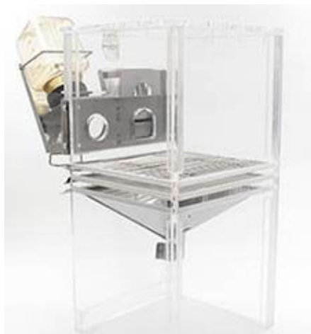
Figura 5 Representación gráfica de una jaula metabólica para la obtención de orina.
