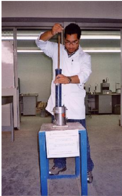
Fig. 3.4. Ejecución de Proctor Estándar.
