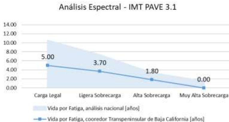
Figura 3.28 Análisis Espectral para Vida por Fatiga en años, Corredor Transpeninsular de Baja California
