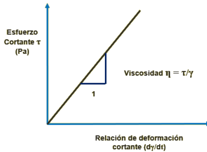
Figura 1.6 Determinación de la viscosidad. Fuente: (Coria Gutiérrez, Hernández Domínguez, & Garnica Anguas, 2018)
