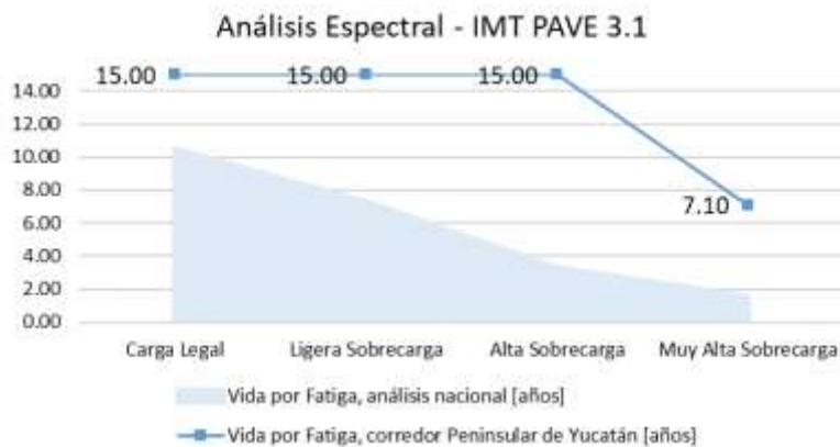
Figura 3.30 Análisis Espectral para Vida por Fatiga en años, Corredor Peninsular de Yucatán
