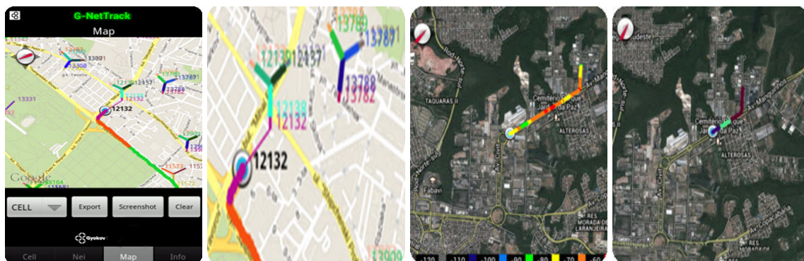
(e) Puntos en rojos niveles \geq a 95 dBm (f) sectores de sitios vecinos (g) Niveles de potencia en el mapa (h) Potencia \leq 80 dBm
