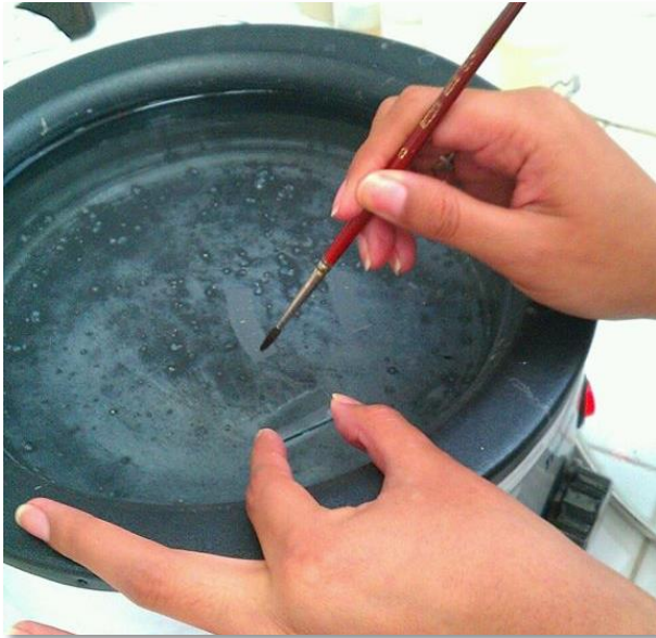
Baño de flotación y montaje de muestras
