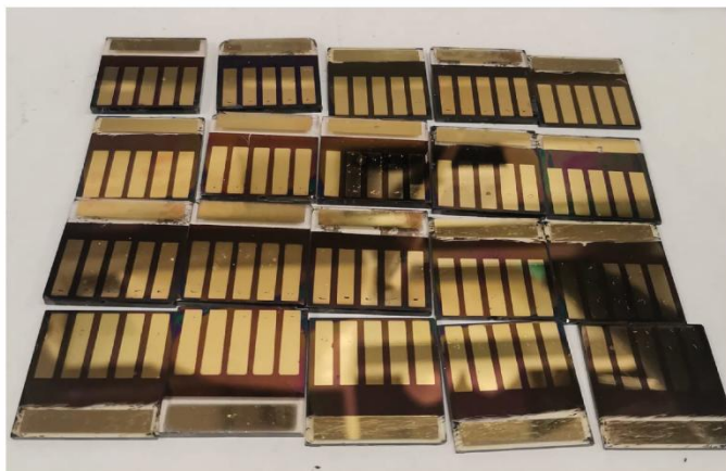
Figura 3.7. Depósito del contacto metálico Au
