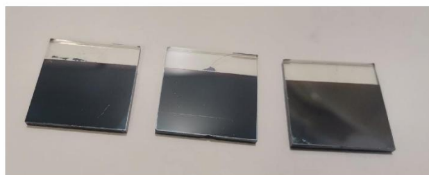
Figura 3.5. Tratamiento térmico de la película de perovskita
