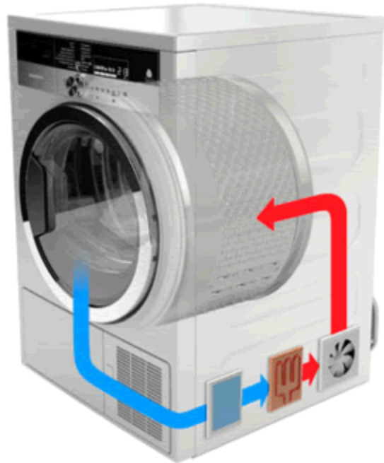
Figura 31. Principio de funcionamiento de una secadora de evacuación.
