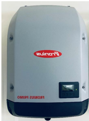
Figura 13. Inversor solar comercial.
