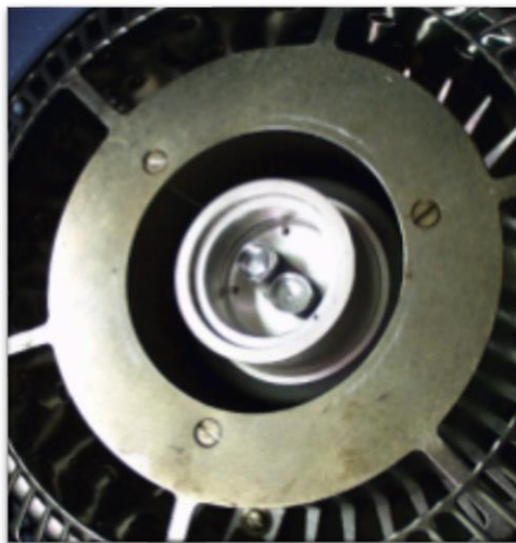
Figura 4. Horno del equipo Q2000 TA Instruments.
