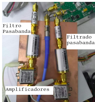
Figura 3.13: Implementación de la etapa front-end que inicia la salida de la antena y termina en la entrada del ADC de la ROACH2.
