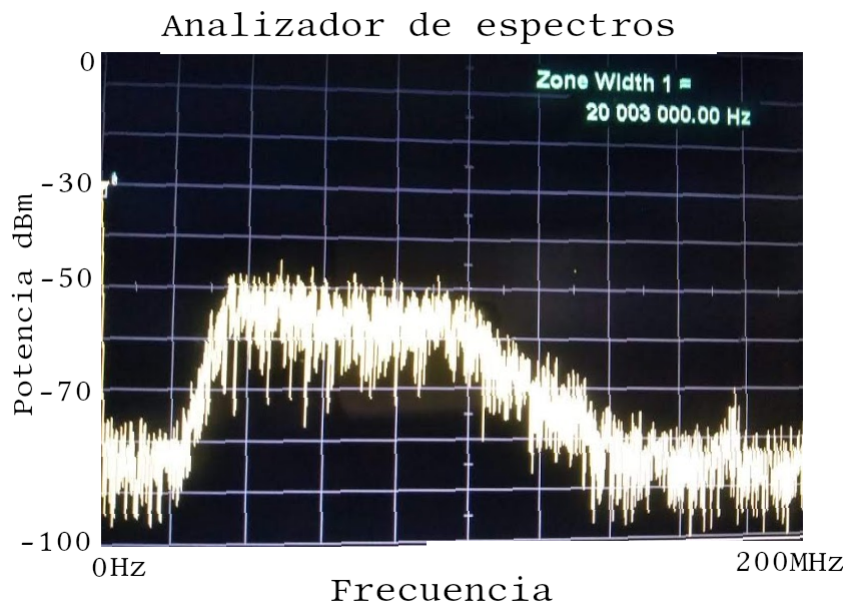
Figura 5.7: Espectro en el medio ambiente captado por un analizador de espectros con la señal tomada del front-end implementado.
