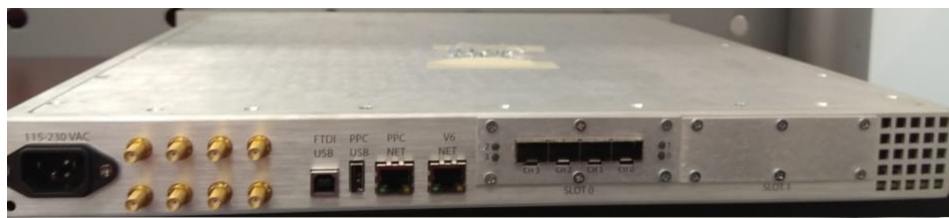
Figura 2.25: Vista posterior de la tarjeta ROACH2, se pueden observar conectores USB y ethernet para la comunicación, conector para alimentación de línea y conectores que pueden ser usados para ingresar señales.
