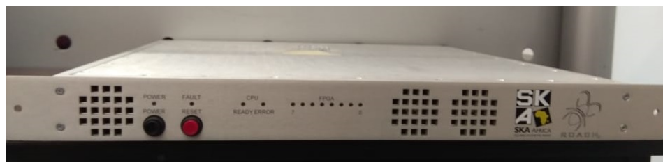
Figura 2.24: Vista frontal de la tarjeta ROACH2, aquí se encuentra el control de encendido (botón negro), reset de Hardware y software (botón rojo) además de leds indicadores programables.
