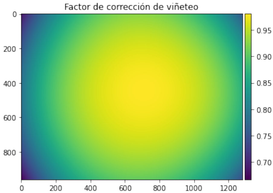
(b) Factor de viñeteo \nu(x, y) en la imagen de irradiancia I_{seq}(x, y) de la banda GREEN.
