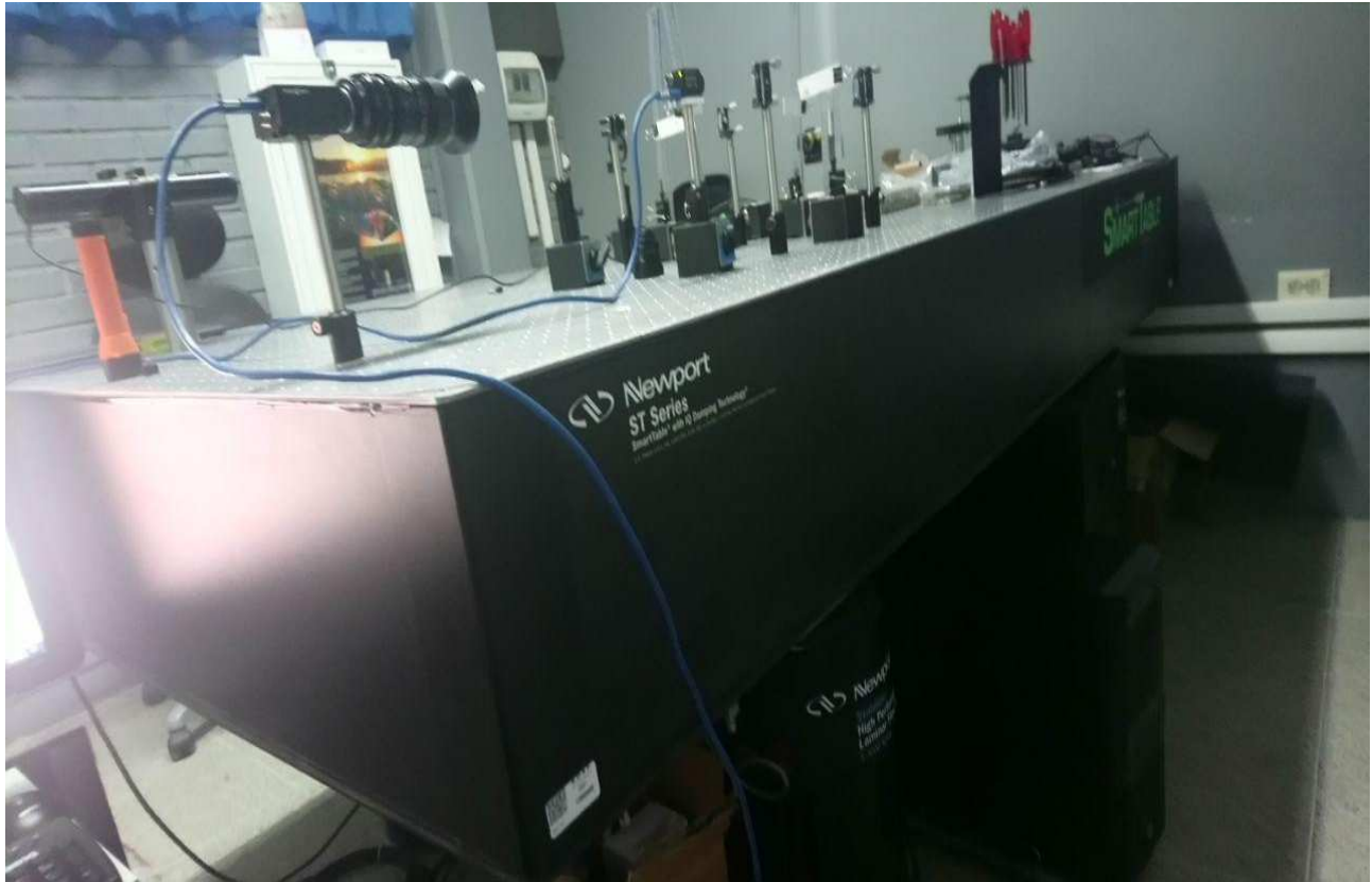
Figura 5.22: Mesa Óptica 3 - Smart Table, cuenta con un sistema de aislamiento de vibraciones mecánicas diseñado para impedir que perturbaciones externas afecten las mediciones realizadas sobre ella.
