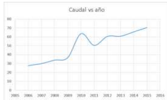
Gráfica 2.1b Caudal de aguas residuales no municipales tratadas a nivel nacional, m^3/s (CONAGUA, 2016).
