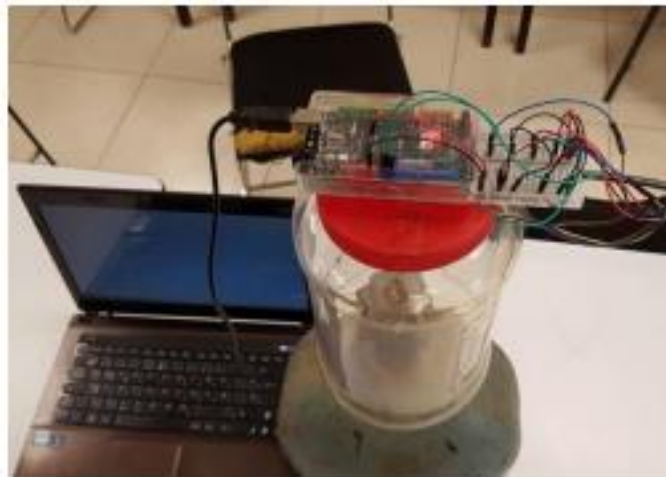
Figura 5. Equipo desarrollado por Carbajal (2018) para la detección de gas licuado de petróleo. Fuente: Carbajal (2018)
