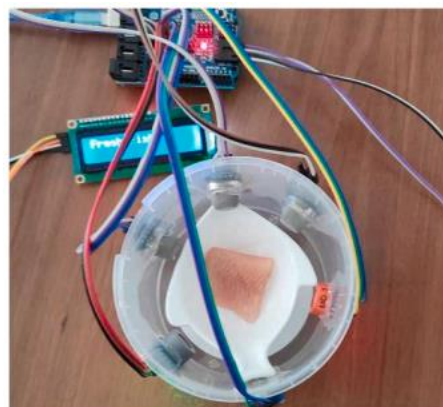
Figura 9. Equipo propuesto por Yavuzer (2021) para analizar pescado crudo. Fuente: Yavuzer (2021)
