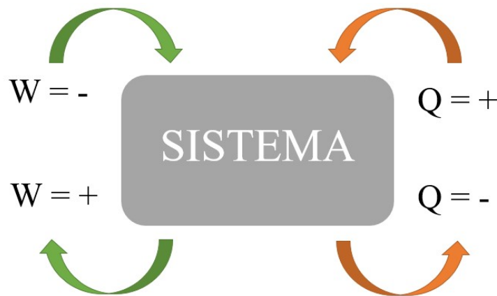
Figura 1.4.2: Representación de cuando el calor y el trabajo tendrán signo positivo o negativo
