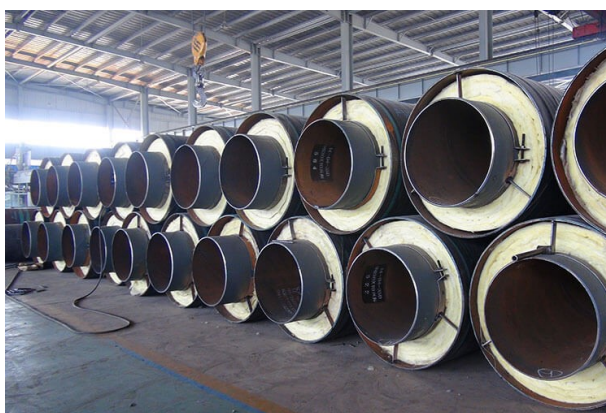
(b) Vista transversal de tuberías con aislamiento [152].
