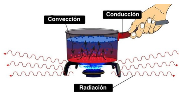
Figura 12.0.2: Mecanismos de transferencia de calor [127].
