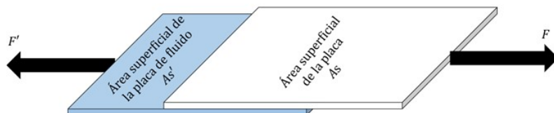
Figura 4.0.9: La fuerza cortante aplicada se resiste uniformemente por el área de la parte que se corta.
