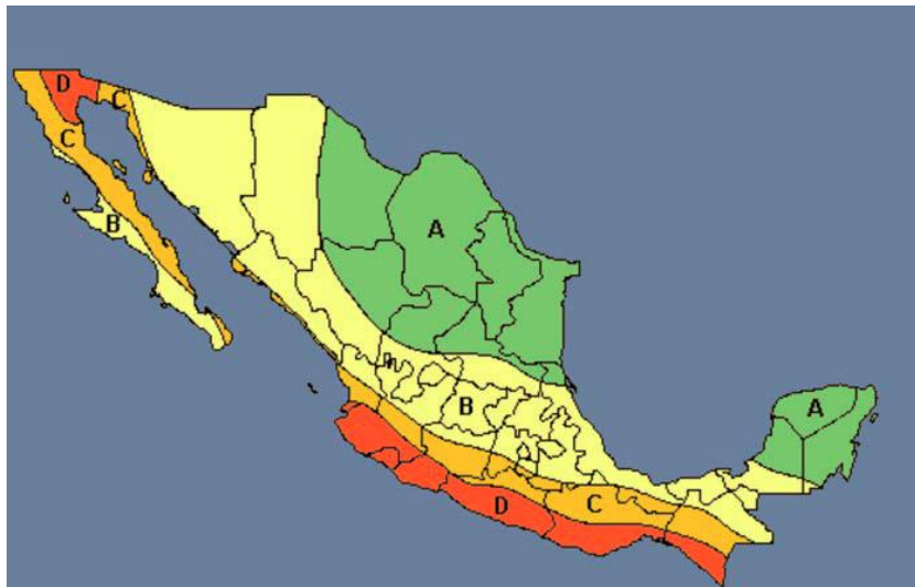
Figura 2.1 Mapa de zonificación sísmica en México. Fuente: Servicio Sismológico Nacional (MOC-93 1993, Tena-Colunga 1999).
