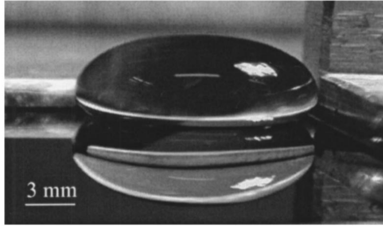
Figura 1.3: Gota de agua depositada en una superficie de silicio a 200 °C. Tomada de Physics of Fluids , vol. 15, núm. 6 (2003) [1].
