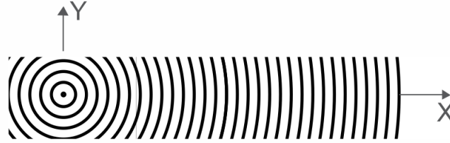
Figura 2.4: Sección transversal de los frentes de onda generados por una fuente puntual. Conforme el frente de onda se aleja de la fuente, localmente es un frente de onda plano
