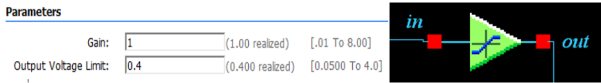
Figura 5.5: Configuración y programación en bloques de la ganancia saturada.
