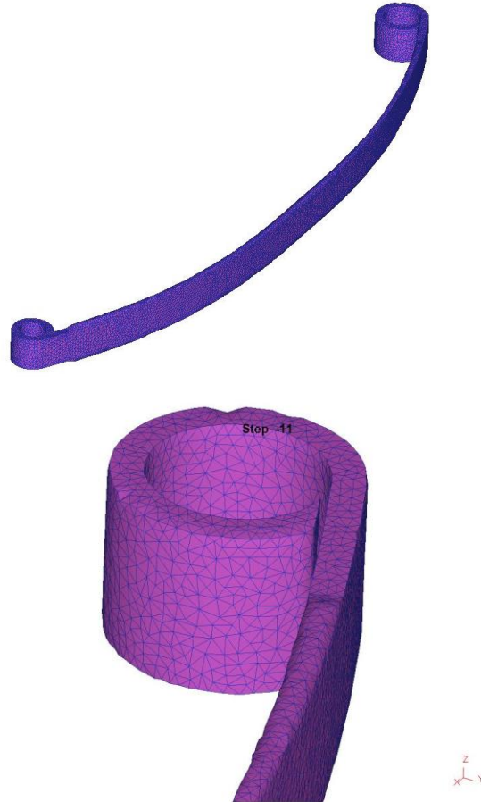
Figura 6.- Geometría inicial de la pieza de trabajo preformada en caliente a temperatura de austenización.
