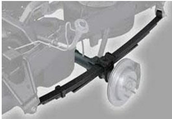
Figura 1.- Ilustración de una muelle automotriz
