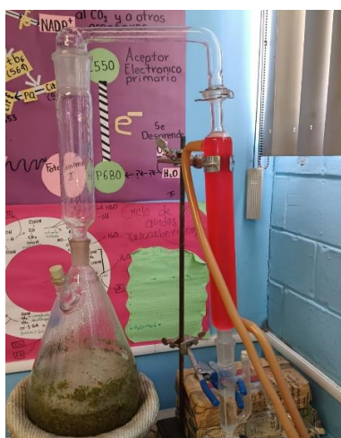
Figura 7.2. Destilador y recirculador utilizados durante la extracción de AE
