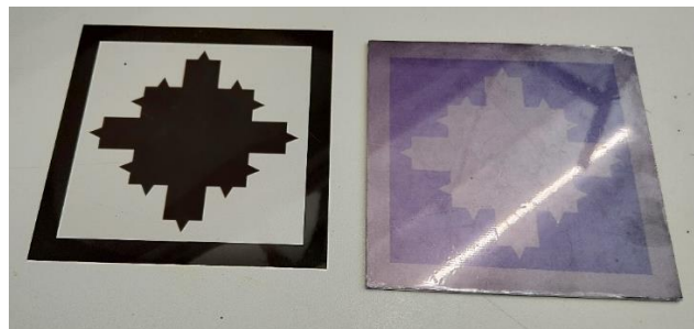
Figura 3.18 Resultado de la exposición a rayos UV de la impresión en positivo sobre la película fotosensible y la placa.
