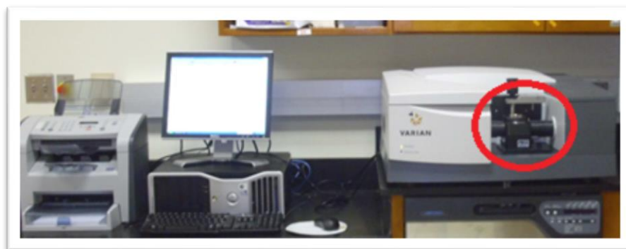
Figura 3.10. Varían 660 IR donde se llevaron a cabo las mediciones de FTIR en modo de reflectancia atenuada total en el rango de 390\text{-}4000\text{ cm}^{-1} .
