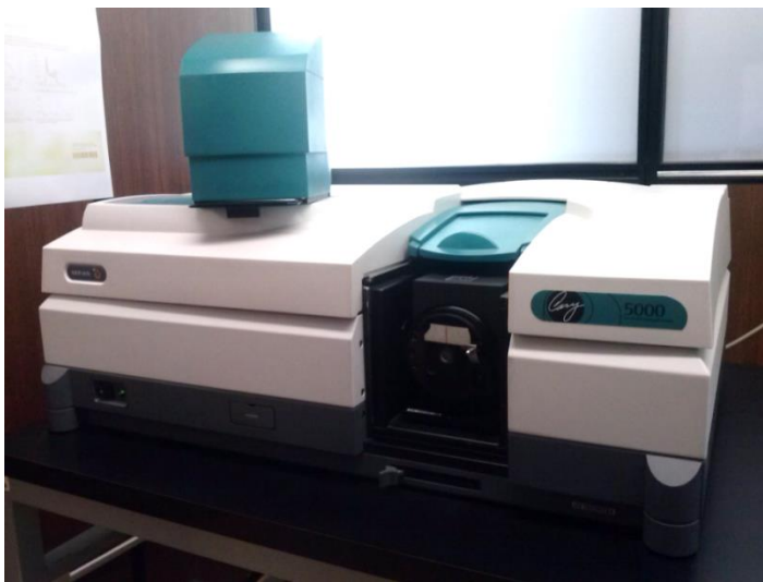
Figura 3.7. Espectrofotómetro, Carry 5000 UV-VIS- NIR. Este equipo utiliza tres fuentes de radiación, para alcanzar un intervalo de trabajo desde los 200 hasta los 2500 nm.
