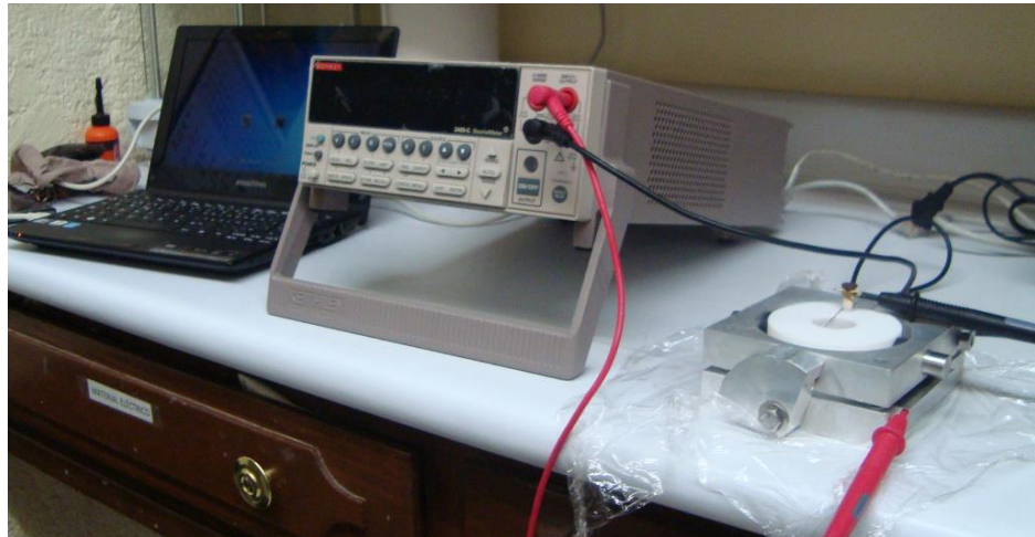
Figura 3.2. Configuración experimental del proceso de anodización electroquímica para la obtención de SP.
