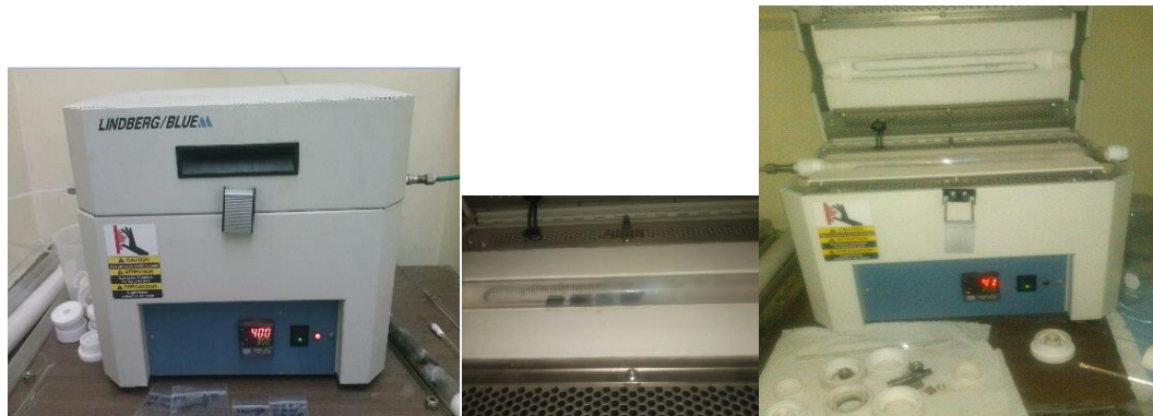
Figura 3.6. Fotografía del equipo utilizado para llevar a cabo la oxidación térmica en ambiente de oxígeno.
