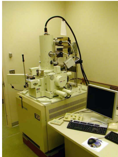
Figura 3.11. JEOL JSM600F utilizado para obtener las imágenes de SEM de la sección transversal de diferentes FM.
