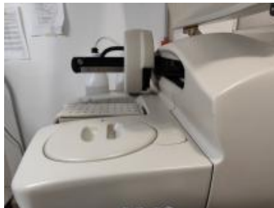
Fig. 13 Lector de ELISA para la detención de la reacción y lectura de absorbancia
