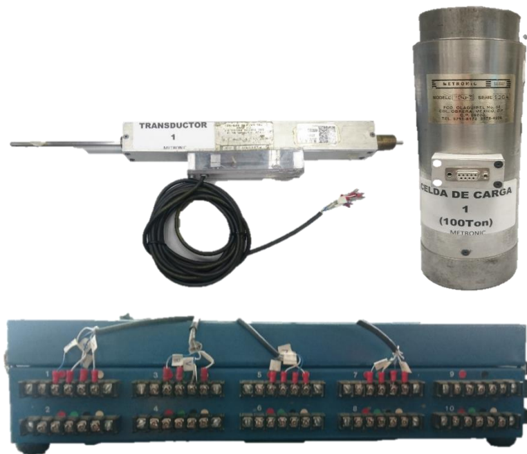
Figura 4-2 Equipo de adquisición de datos METRONIC
