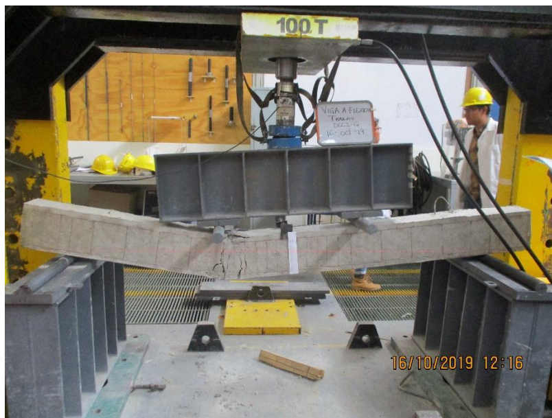
Figura 5-7 Imagen a colapso
