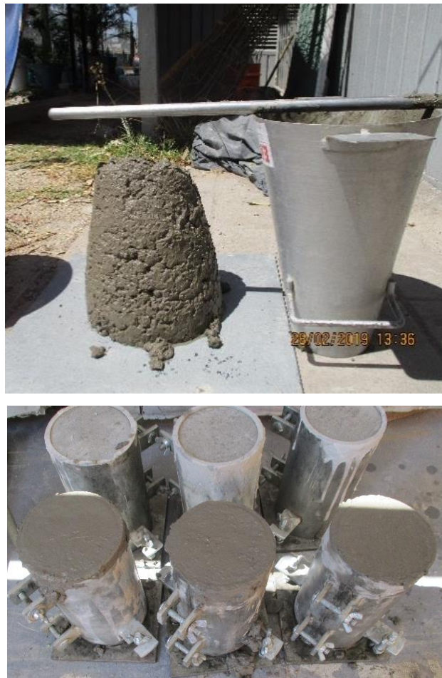
Figura 5-4 Cilindros muestreados y toma de revenimiento
