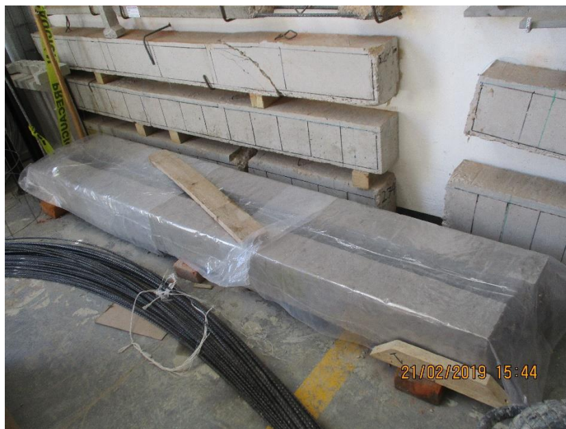
Figura 5-5 Proceso de curado del elemento
