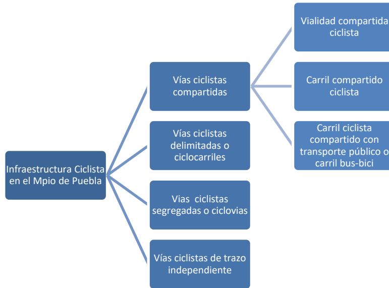
Ilustración 28. Clasificación de Infraestructura Ciclista en el Municipio de Puebla Fuente: Norma Técnica de Diseño e Imagen Urbana para el Municipio de Puebla. (2015)
