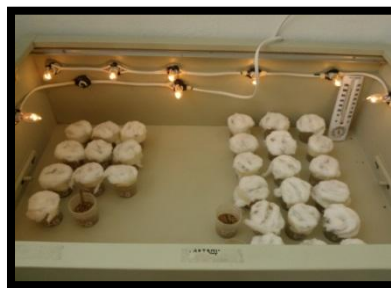
Figura 8. Espacio de monitoreo de brotes de papa con sistema de iluminación con reloj temporizador.
