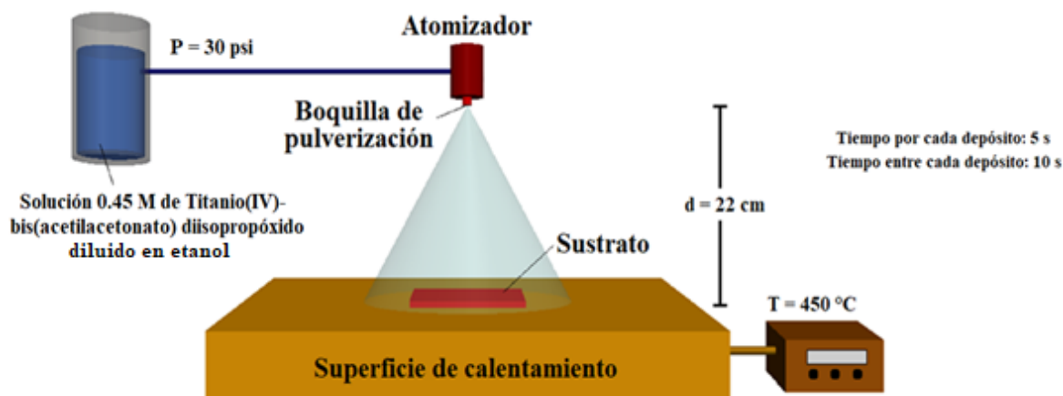
Figura 3.3. Esquema representativo de las condiciones experimentales empleadas para realizar depósitos de capa compacta de \text{TiO}_2 mediante el método de rocío pirolítico.
