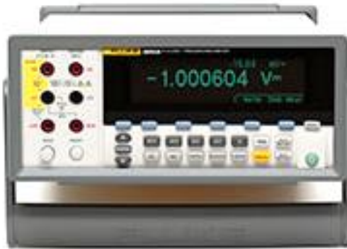
Figura 2. Multímetro de precisión de 6,5 dígitos 8845A/8846A (FLUKE, 2023a.)
