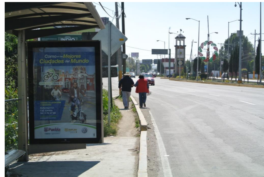
Ilustración 32 La poca atención al mantenimiento del borde ocasiona que las personas caminen por el arroyo vehicular. Fotografía propia tomada en sitio.
