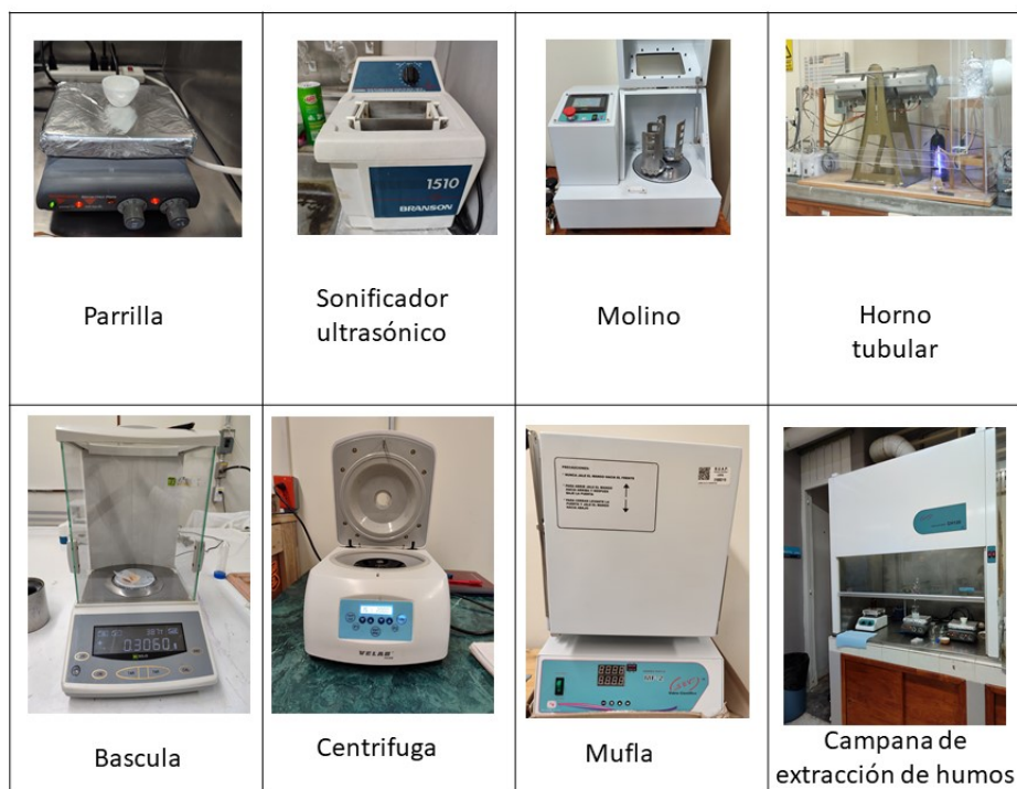
Figura 17: Fotografías de los instrumentos de laboratorio utilizados en la fabricación de polvos \text{CaWO}_4:\text{Eu}^{+3}
