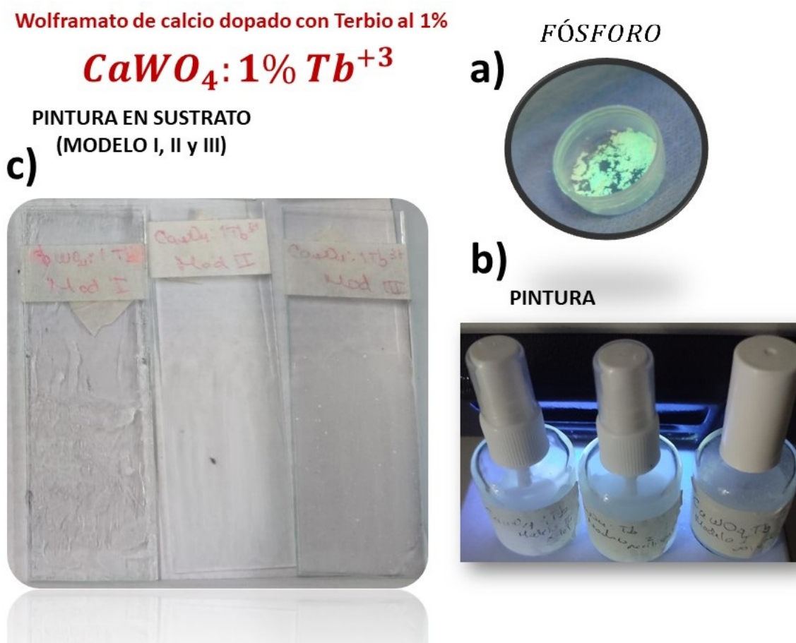
Figura 50: Imágenes del a) Fósforo \text{CaWO}_4: 1\% \text{Tb}^{+3} (Wolframato de calcio dopado con terbio), b) Pintura elaborada con el fósforo \text{CaWO}_4: 1\% \text{Tb}^{+3} y c) Aplicación de las pinturas \text{CaWO}_4: 1\% \text{Tb}^{+3} en sustratos de vidrio
