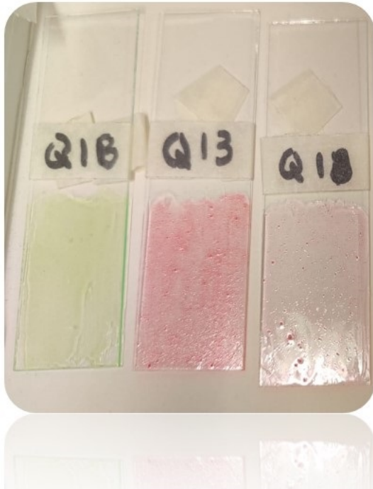
Figura 62: Imágenes de los a) Fósforos comerciales ZQ 11, ZQ 13, ZQ 18, b) Pinturas elaborada con los fósforos ZQ y c) Aplicación de las pinturas ZQ en sustratos de vidrio
