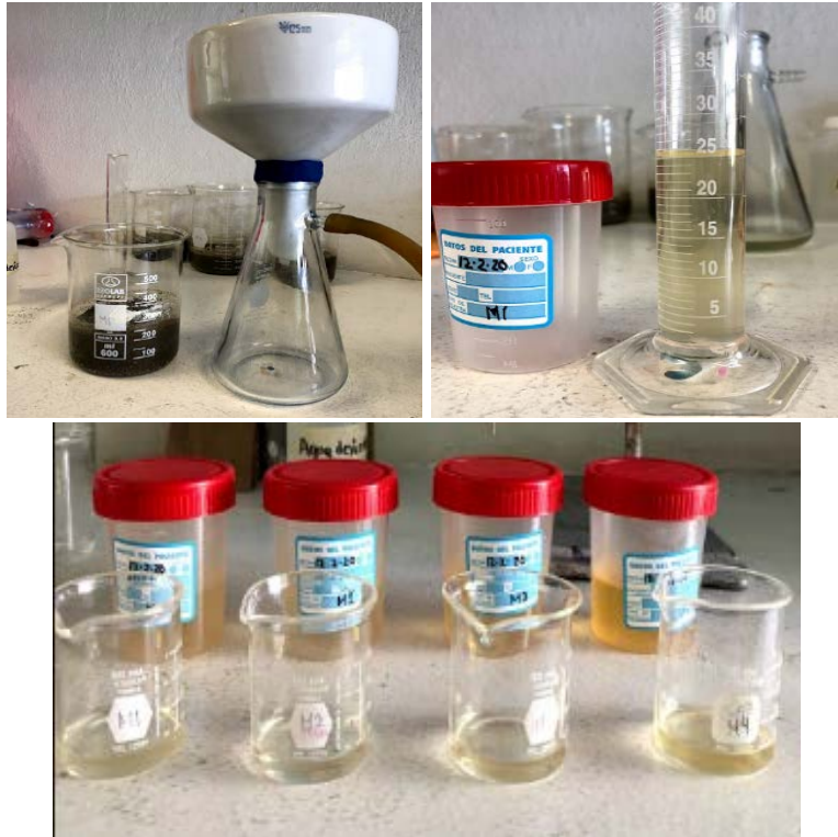
Figura 18. Obtención del extracto de saturación. Nota. De acuerdo con el método (AS-16) de la NOM-021-SEMARNAT-2000. Elaboración propia.
