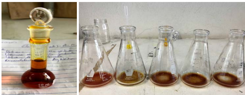
Figura 20. Determinación de aniones solubles: Cloruros. Nota. De acuerdo con el método (AS-20) de la NOM-021-SEMARNAT-2000. Elaboración propia.
