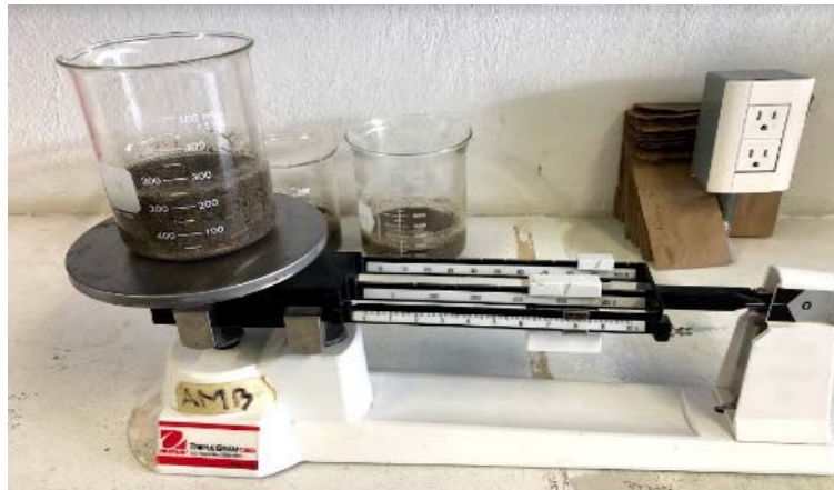
Figura 17. Preparación de la pasta saturada. Nota. De acuerdo con el método (AS-16) de la NOM-021-SEMARNAT-2000. Elaboración propia.
