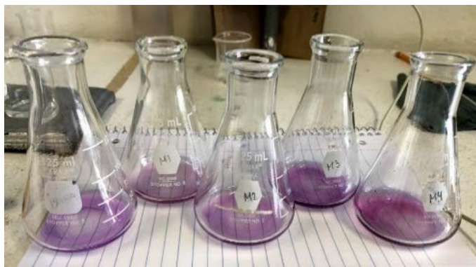
Figura 21. Determinación de cationes solubles. Calcio. Nota. De acuerdo con el método (AS-19) de la NOM-021-SEMARNAT-2000. Elaboración propia.
