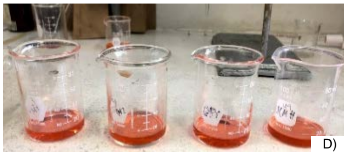
Figura 19. Determinación de carbonatos y bicarbonatos. Nota. A) Indicador de fenolftaleína. B) y C) Determinación de carbonatos. D) Determinación de bicarbonatos De acuerdo con el método (AS-20) de la NOM-021-SEMARNAT-2000. Elaboración propia.
