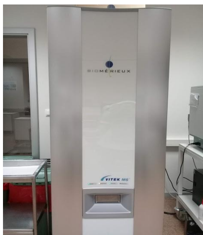
Figura 12. Equipo MALDITOF VITEK MS IVD utilizado en la identificación molecular por proteínas.
