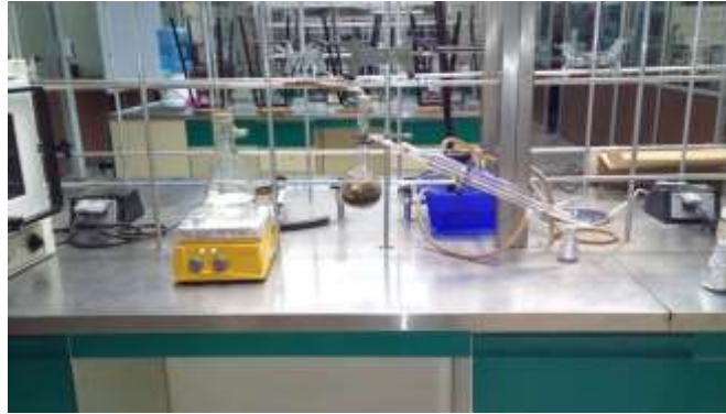
Figura 35. Se emplea una destilación por arrastre de vapor para obtener el fenol.
