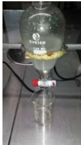
Figura 36. Se emplea un embudo de decantación para la extracción de aceites esenciales presentes en la planta.
