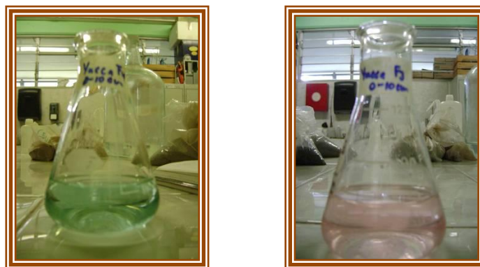
Fig. 47 Ejemplo de coloración de muestra antes y después de valoración de % Nitrógeno Total
