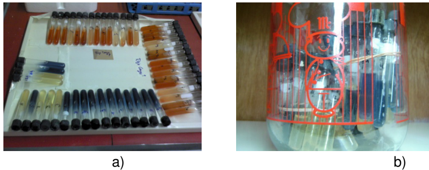
Fig. 4.1. Fotografías de los tubos de ensaye en condiciones de respiración a) aerobia y b) anaerobia del Rojo Congo y Azul de Levafix CA, a las 24 horas.
