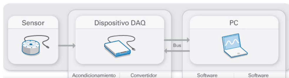
Figura 2.2: Flujo de adquisición de datos: el sensor envía la señal al dispositivo DAQ, que la convierte y transmite a la PC para su procesamiento.
