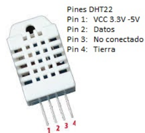
Figura 3.2: Sensor Digital Humedad Relativa y Temperatura DHT22 [36].
