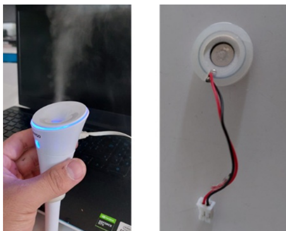
Figura 3.3: a) Humidificador comercial Miniso, b) Transductor piezoeléctrico
